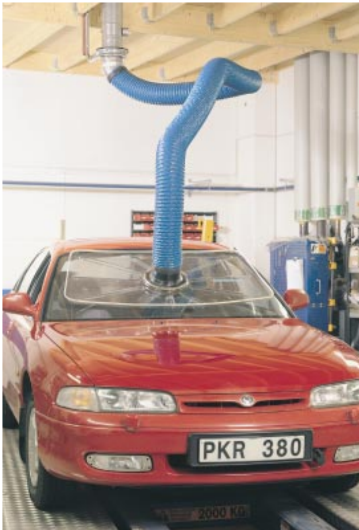
Punktutsuget använt för utsugning av ånga och rök vid byte av vindruta.
